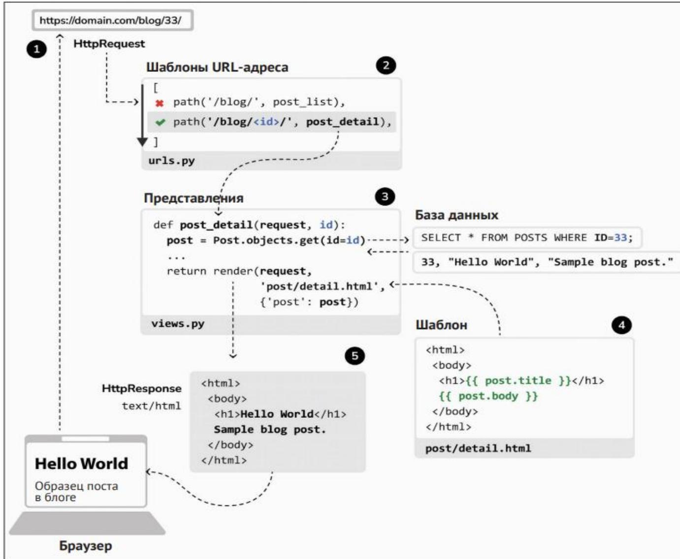
Указанную схему всегда можно использовать в качестве базового ориентира в отношении того, как Django обрабатывает запросы. В целях простоты данная схема не содержит промежуточные программные компоненты Django.
